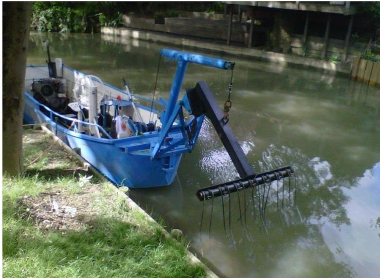
Figure 2 : Exemple de griffe utilisée pour le faucardage des algues invasives
